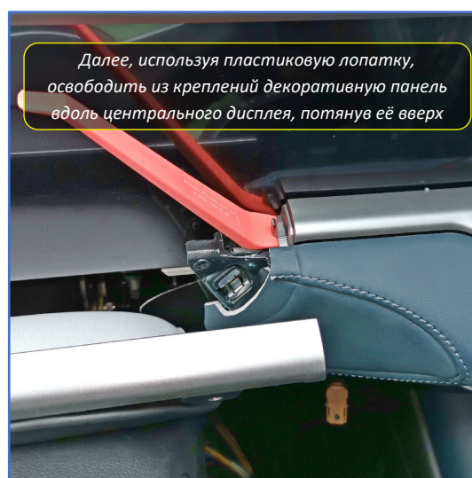
Рис. 4.1 и 4.2. Доступ к местам подключения
