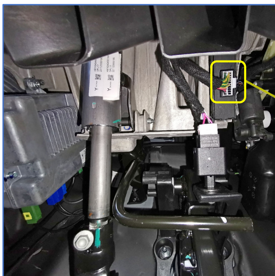
Рис. 3.7 и 3.8. Разъём IP44 блока Gateway над педалью тормоза
