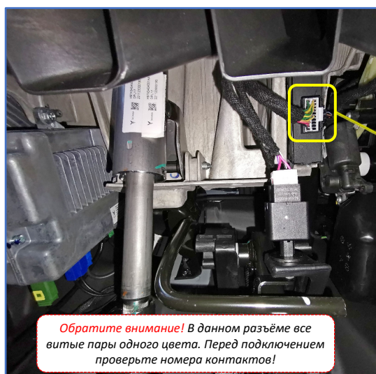
Рис. 3.3 и 3.4. Разъём IP44 блока Gateway над педалью тормоза
