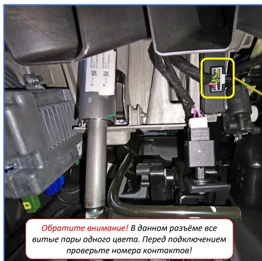
Рис. 3.5 и 3.6. Разъём IP44 блока Gateway над педалью тормоза
