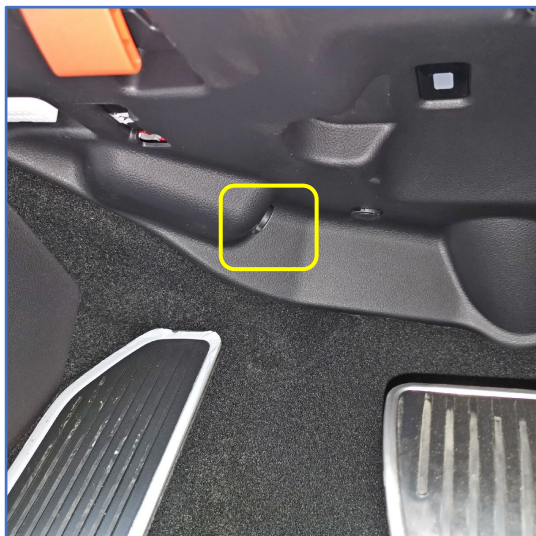
Рис. 6. Возможное место размещения кнопки «VALET»
