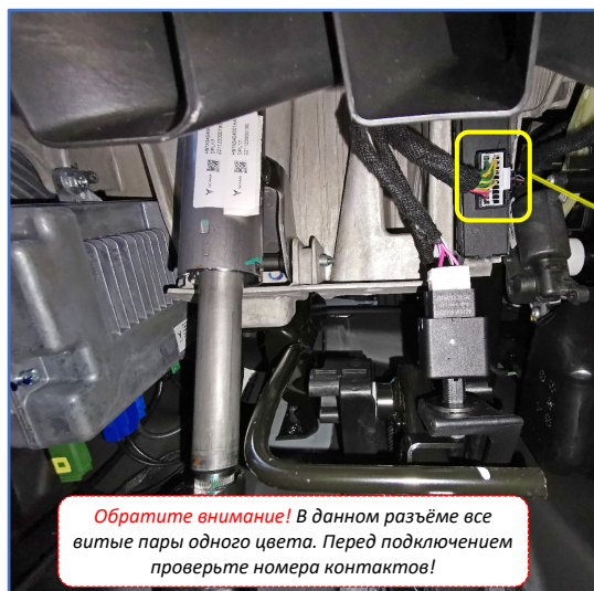
Рис. 3.1 и 3.2. Разъём IP44 блока Gateway над педалью тормоза
